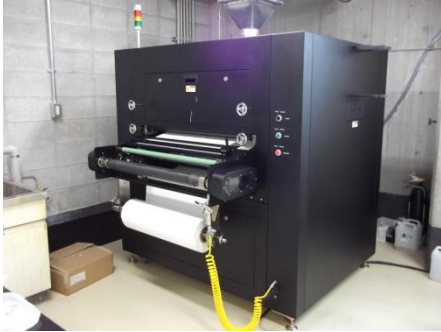
エレクトロスピンニング装置： 高い透湿防水効果を有するナノファイバー不織布を作製します。
