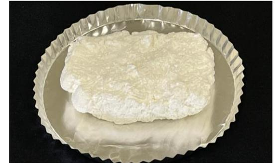
図2 真空凍結乾燥したCNFの様子(重さ9.73g)
