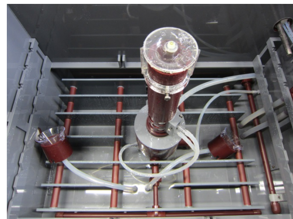
立てかけ用試料枠を外した状態(写真は塩水部)： 大きい品物や10kgf以下の重い品物も入ります。
