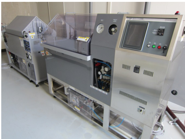
腐食環境サイクル試験システムの外観： 中性塩水を使用する試験を行う槽(右側＝塩水部) とそれに酢酸と塩化銅(II)を加えたキヤス溶液を使用する試験を行う槽(左側＝キヤス部)があります。
