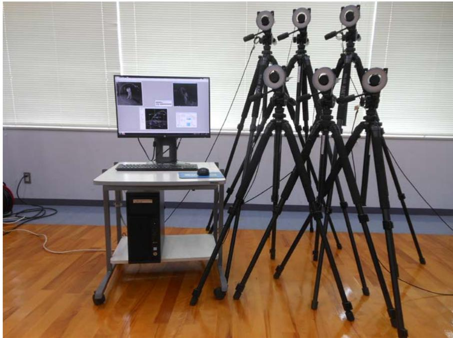
距離、速度、角度等の演算機能を有し、人間の日常動作解析、ゴルフスイング、ピッチング等のスポーツ動作解析、スポーツウェアの挙動解析などに利用できます。
