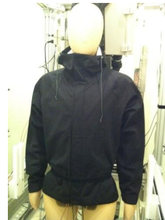
ナノファイバー不織布を用いて開発したウェアの快適性を評価しているところ。
