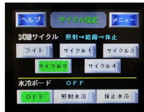
照射、結露、休止のサイクル試験
