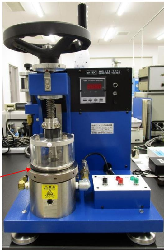
破裂強度試験機の外観
