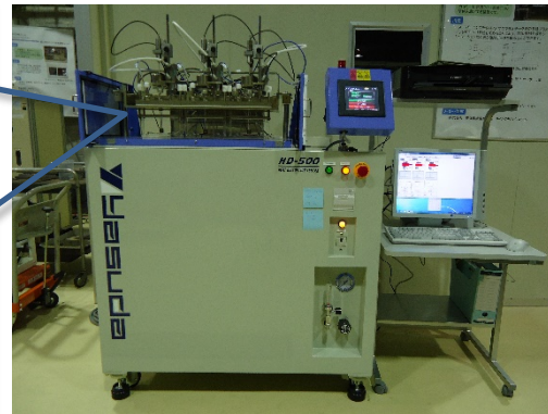
熱変形温度測定装置
