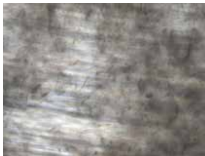
せん断力を印加されたセルロースナノファイバー懸濁液の”その場観察”
