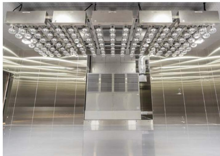
天井固定式日射装置(試験室内部)
