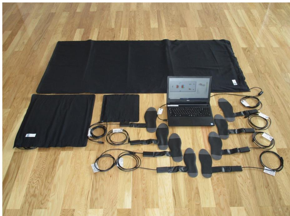
各種センサを使用することにより、椅子やクッションへの着座時の圧力分布、マットレス等の就寝時や横臥時の体圧分散状態、歩行時や立位時の足裏圧や接地状態など、日常生活や運動動作時における身体各部に作用する静的・動的な負荷圧力の測定・解析が可能です。
