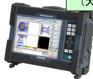
○可搬超音波探傷検査装置 (現場用:金型や構造部材にも対応)
