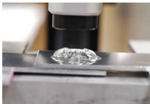
(a) ゲルの塗布状況(多い)
