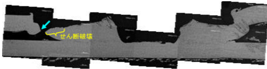
図 5-30 引張試験後のナゲット部断面 (A1050、1t)
