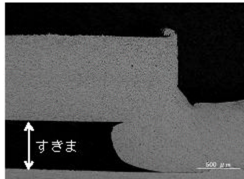
図 5-34 重ね合わせ面に生じたすきま (A1050、1t)
