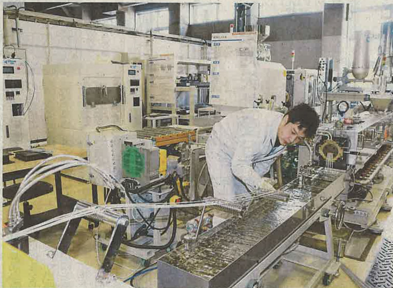
押し出し機から伸び出てくるCNFと樹脂の複合材料―県ものづくり研究開発センター
