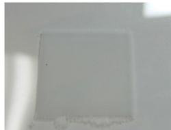
○交流インピーダンス測定の結果から約 $2 \times 10^{-7}$  (S/cm)のイオン伝導を示す固体電解質膜を作製できた。
