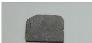
正極基板に固体電解質を塗布
