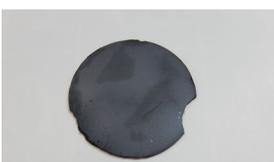
正極基板(コバルト酸リチウム)
