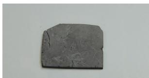
正極基板(コバルト酸リチウム)
