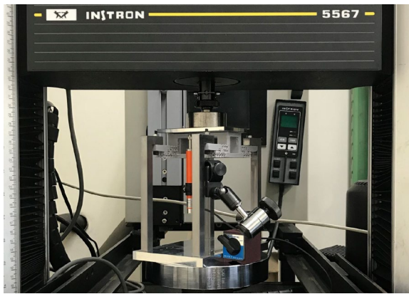
万能試験機による試験体の剛性評価
