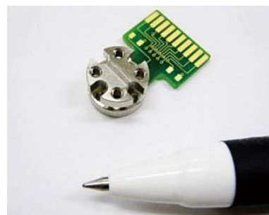
超小型3軸力覚センサ (株)ワコーとの共同研究 平成23年(2011)
