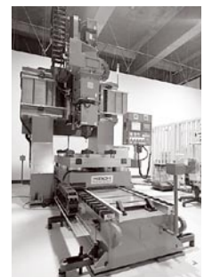
2次元摩擦撹拌接合装置
