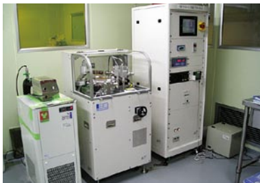
小型プラズマプロセス装置TEP-01™ 立山マシン(株)との共同研究 平成21年(2009)
