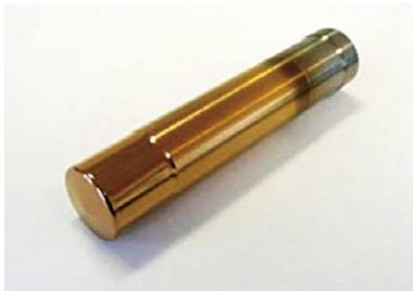
窒化チタン・モリブデンコーティング (株)北熱との共同研究 平成20年(2008)
