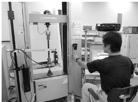
写真2-4 プラスチック強度試験機
