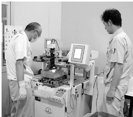
写真2-17 精密スクリーン印刷機を用いたセンサの開発研究
