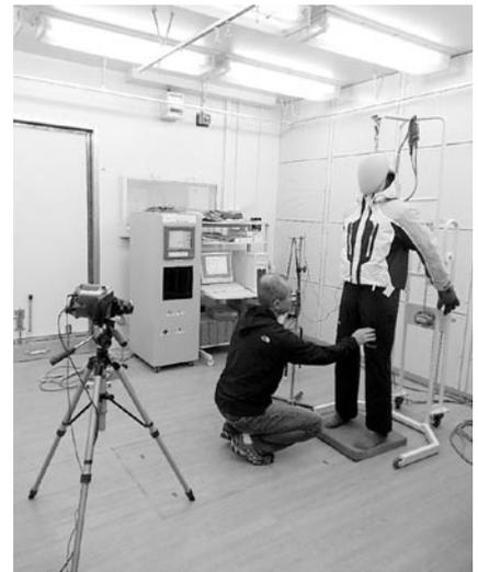
写真2-10 人工気象室(温熱生理計測室)でのスキーウェアの保温性評価試験
