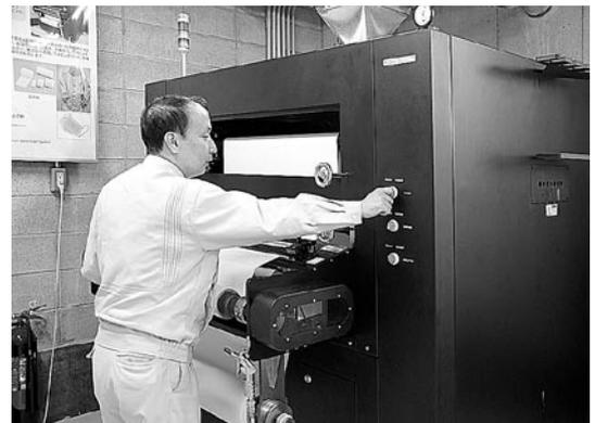
写真2-19 エレクトロスピンニング装置
