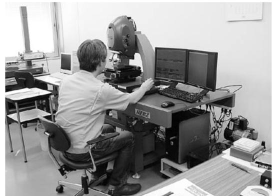
写真2-14 非接触三次元粗さ測定装置による機械部品の形状測定
