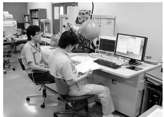
写真2-16 FEオージェ電子分光分析装置による電子デバイスの分析
