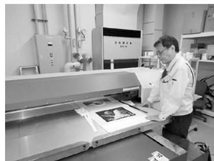
写真2-13 オートダイニング装置によるプリント試験
