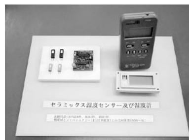
図1-20 セラミックス湿度センサー及び湿度計
