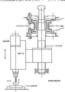
図3-31 小型ドリリングセンターへの検出器取り付け概要
