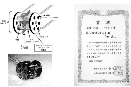
図2-15 試作した小型自走マシンと賞状
