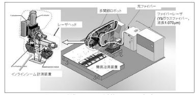
図1-13 開発したレーザ溶接システムの概略
