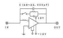
図3-29 試作した検出装置と組み込まれたチャージアンプ回路
