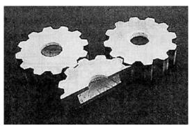
図1-7 AI-12%Si合金製試作中空形状ギア
