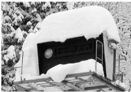
図3-13 試験設置した道路標識板用の滑雪板(2003.1.4) (左:光触媒板、右: 既設の塗装板)
