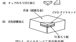
図2-3 ダイヤモンド工具作製手順
