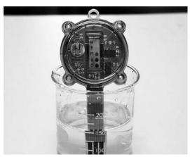
図3-18 樹脂基板に電子回路を印刷した肥料計
