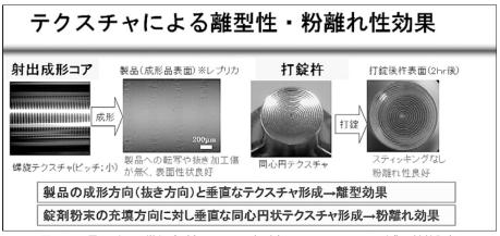
図1-12 電子ビーム微細溶融加工による金型表面でのテクスチャ形成と性能評価
