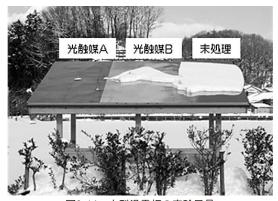
図3-14 大型滑雪板の実験風景 (左から:光触媒A:黒色板、光触媒B:無色板、SUS板)
