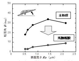
図3-15 表面粗さと模擬湿り雪を用いた転落角
