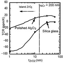
図3-16 ZrO<sub>2</sub>バッファ層付NiCr薄膜のTCR のバッファ層厚さ依存性
