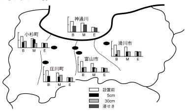
図5-6 設置場所別に見た引張最大荷重の変化(170日) B:バイオポール、M:マタービー、E:エコスタープラス 縦軸は引張荷重(フルスケール100kgf)を示す
