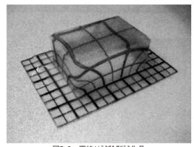
図5-8 深絞り試験型試作品
