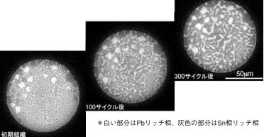
図3-27 フリップチップはんだボール接合部の組織変化例
