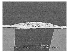
図3-10 開発した厚膜圧電アクチュエータ断面
