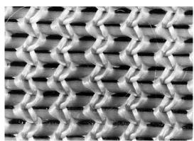
図4-1 よこ糸挿入トリコット地表面
