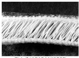
図4-2 透水性能を有する加工基布例
