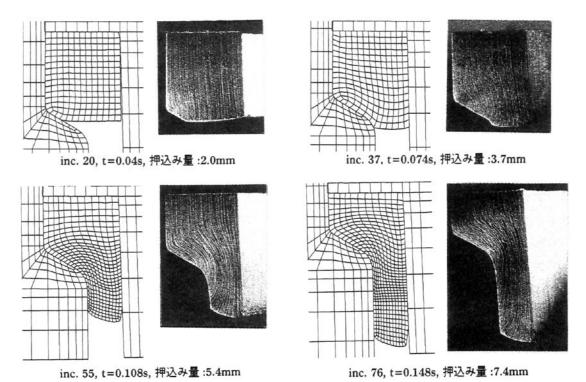
初期形状 inc. 125, t=0.248s, 押込み量:12.4mm inc. 152, t=0.298s, 押込み量:14.9mm 図2-10 第2工程における変形形状
