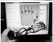
図3-20 開発した3軸フォースセンサ(上) とロボットハンドへの実装例(下)
