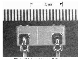
図2-1 試作したダイレクト温度センサ
