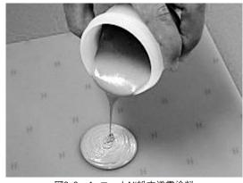
図3-3 AgコートNi粉末導電塗料
