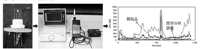
図3-11 開発したT-VOCセンサと試作計測装置
