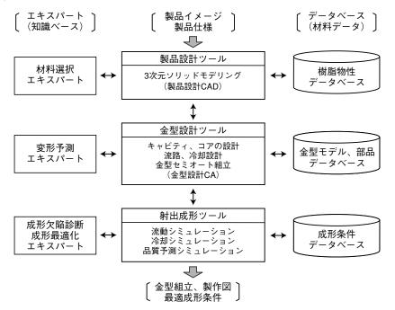
図5-1 プラスチック成形シミュレーションシステム (IMAST) 構成図
