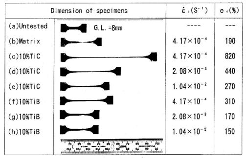
Test Temp. = 963K C. H. S=Const. Ar Atomosphere 図1-3 高温引張試験後の試験片の概観
