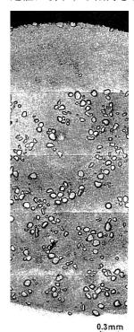
図1-5 Al-Cu-TiC複合化層のミクロ組織
