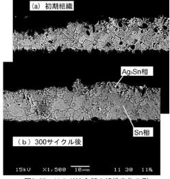
図3-25 はんだ接合部の組織変化の例
