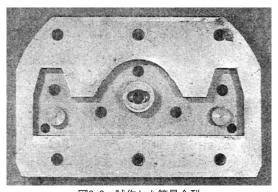
図2-6 試作した簡易金型
