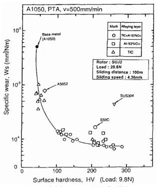
図1-6 複合化層の硬さと比摩耗量の関係
