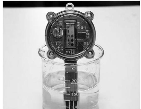
図3-18 樹脂基板に電子回路を印刷した肥料計
