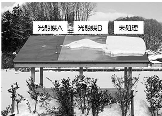
図3-14 大型滑雪板の実験風景
