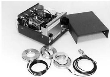
図3-29 試作した検出装置と組み込まれたチャージアンプ回路
