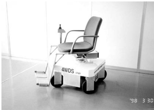
図9-3 4輪駆動4輪操舵方式電動車椅子
