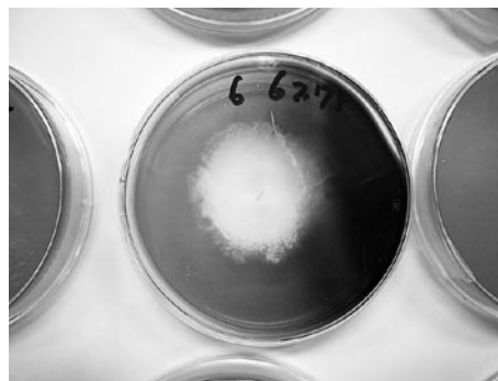
図8-15 褐色腐朽菌による有機塩素化合物の分解（白い部分が分解されている）
