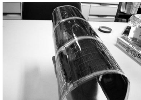
図8-12 フレキシブル性色素増感太陽電池
