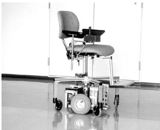
図9-1 中輪駆動型6輪方式電動車椅子
