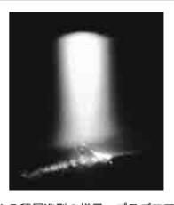
DPF法による積層造型の様子。プラズマアーク柱の 熱で溶けた供給粉末が基材上に落下し溶融池を形成 しています。
