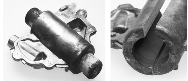
図2 鋳造試験片とその中子除去後の外観
