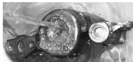
図2 鋳造試験片とその中子除去後の外観
