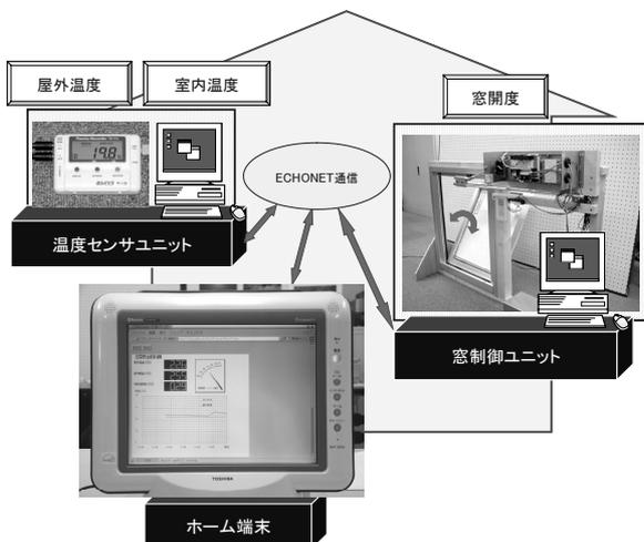
図2 開発システムの構成
