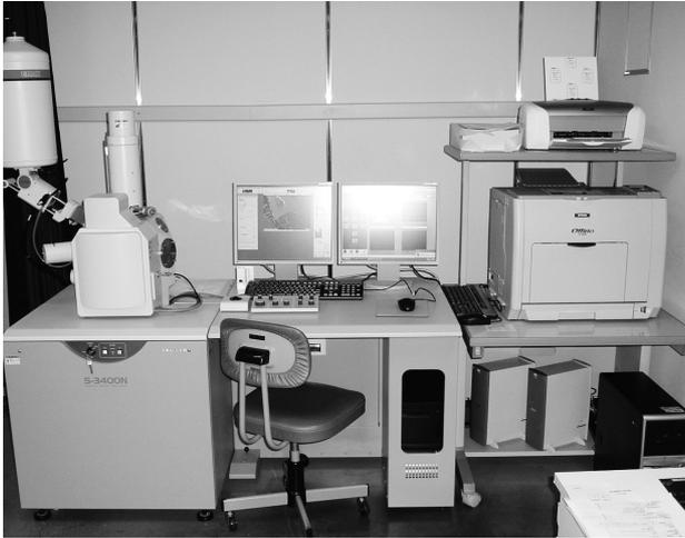
材料や製品表面へ絞った電子線を照射し、微細表面構造を観察する顕微鏡です。また、X線分析装置と組み合わせることで、試料を構成する元素の確認やその画面上における分布に関する情報を得ることも出来ます。
