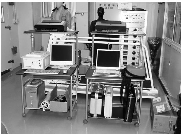
本装置は、歩行や走行運動を行う運動負荷装置および生体の運動負荷を評価する呼吸代謝装置で構成され、身体のエネルギー消費量や酸素摂取量、二酸化炭素排出量を測定し、身体の活動量や疲労度の評価を行うことができる装置です。データロガー方式の呼吸代謝装置も付属されており、野外での計測も行うことができます。
