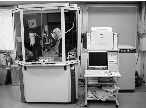
本装置は、X線を試料に照射し、試料により回折したX線のパターンを測定する装置で、試料の結晶構造評価、物質の同定、残留応力測定が可能です。有機物、無機物、金属といった固体試料が主な対象物で、分析領域が100～800  $\mu\text{m}$ と小さいため、電子部品のような微小な試料や特定の場所、微量なサンプルを測定するのに適しています。
