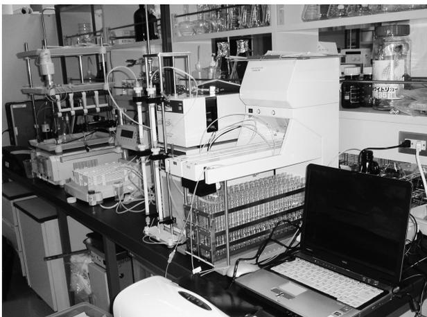
本装置は、ポンプ、カラム、検出器、分取部から構成され、化学薬品やタンパク質などの有機化合物の混合物をカラム内で分離し、回収することによって、目的とする物質の精製を行うことができる装置です。
