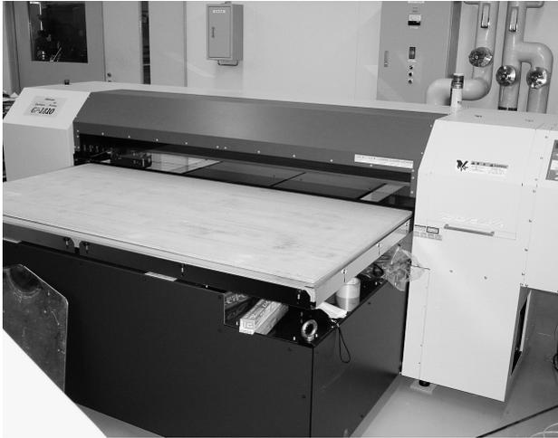
本装置は、複数の染料インクを同時に印捺でき、それにより複数の素材からできている布帛等にデジタルデザインを直接印捺するものです。
