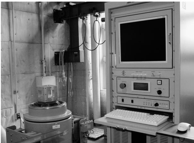
本装置は、上下方向の振動を試験体に加え、試験体の耐久性や振動応答特性を評価する装置です。試験体を、試験機または当センターで所有している取り付け治具に取り付けて、試験を行います。
