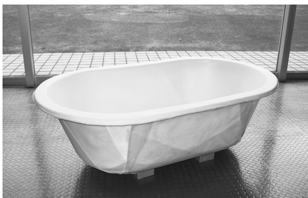
ポリ乳酸シートから試作したバスタブ 試作品は側面をポリ乳酸布の積層により補強した。
