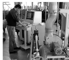
図3 バット用NC旋盤
