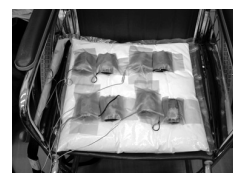
図2. 樹脂粉末入りの袋の間に挟んだ振動モータ
