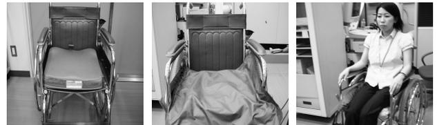
図1 スポンジ状クッション 図2 シートセンサー ション 図3 着座試験
