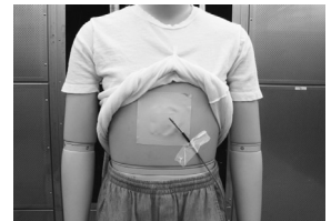
図4 擬似皮膚と温湿度センサーを取り付けた状態
