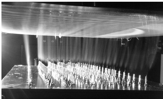
図1．紡糸状況（下がノズル、上がターゲット）
