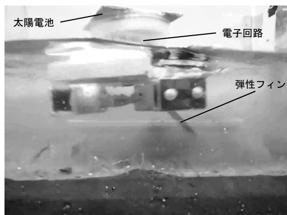
図2 試作機による濁水化実験
