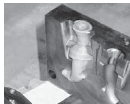
アルミニウムダイカスト用崩壊性中子 スズキ部品富山との共同研究 平成20年(2008)
