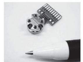
超小型3軸力覚センサ (株)フコーとの共同研究 平成23年(2011)
