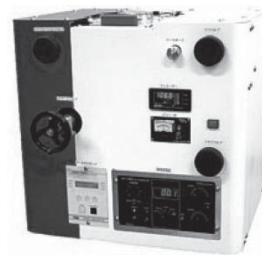
卓上型プラズマ微細加工装置 立山マシン(株)との共同研究 平成22年(2010)
