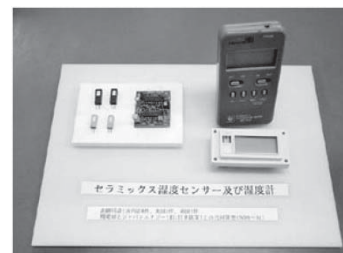
セラミックス湿度センサー及び湿度計 (株)日本鉱業との共同研究 昭和60年(1985)
