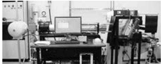
図2 反発性試験装置外観
