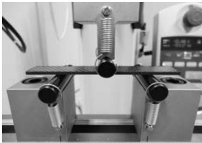
図2 CFRTP平板の3点曲げ試験
