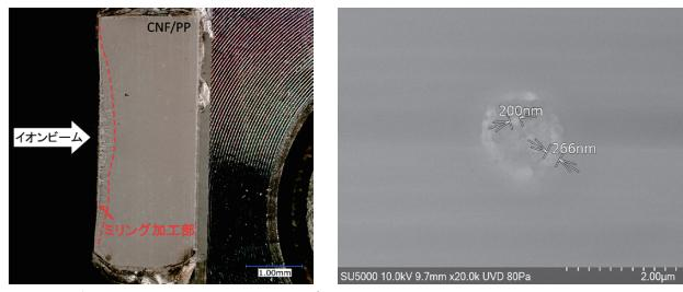
ミーリング加工した CNF 複合化プラスチックの外観写真と断面 SEM 像
