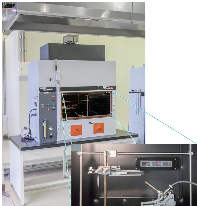
水平燃焼試験用(UL94HB)ホルダー
