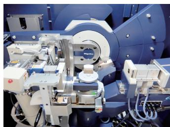
装置内部(水平試料台)
