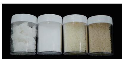
試作したセルロースナノファイバー / 樹脂複合材料
