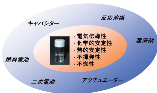
図1 イオン液体の性質を活かした応用分野
