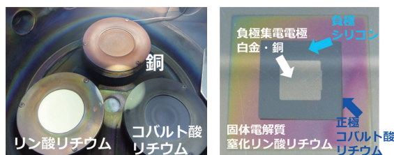
図2 装置内スパッタリングターゲット(左)とガラス基板上に成膜した薄膜2次電池外観(右)
