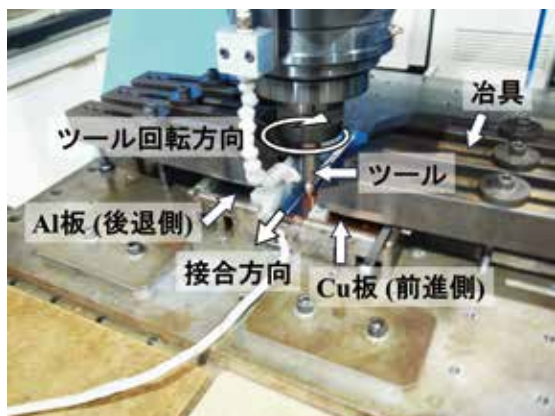
図1 接合試験の外観
