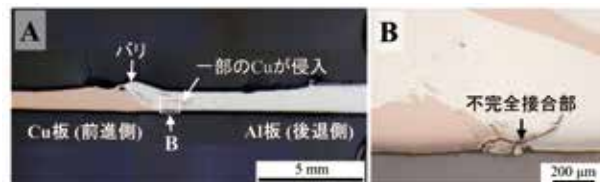
図2 接合部断面のマクロ組織 (A) とミクロ組織 (B)
