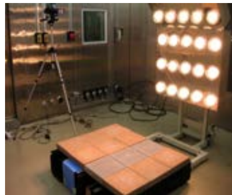
人工気象室の実験風景 (左上:熱画像装置、右上:日射装置、下:試験体)
