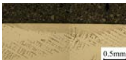
YAGレーザー照射部縦断面の光学顕微鏡写真
