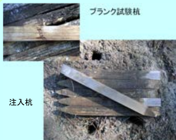
図2 ブランク試験杭のシロアリ跡と銀注入試験杭
