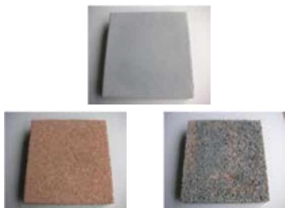
非透水・透水性インターロッキングブロック 上:非透水、下左:透水性(表)、下右:透水性(裏)
