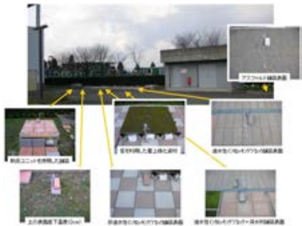
各ブロックの表面温度計測 (生活工学研究所 屋外設置試験)
