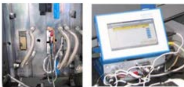
(a): センサ組み込み金型 (b): 金型内圧温度測定解析装置
