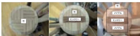
竹合板バットおよび開発した複合バットの断面 (左: 竹合板、中: 竹複合①、右: 竹複合②)
