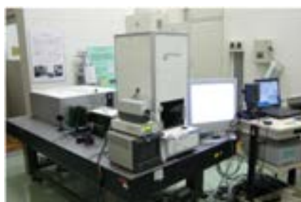
テクスチャの作製装置(フェムト秒レーザー)
