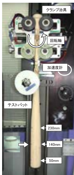
ボール衝突試験により、バットの強度や反発性能およびインパクト時の打撃感触の評価を行いました
