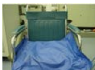
図2. 褥瘡予防クッションの上にシート状の圧力センサーを敷いたもの
