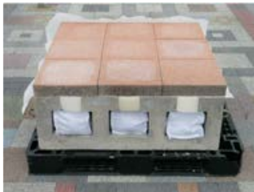
試作したユニット(新ユニット) (床ユニット、保水材、シート、透水性のブロック)
