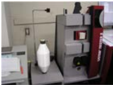
連続糸むら径測定装置 (石川県工業試験場に設置)
