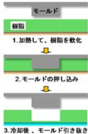
図1 熱ナノインプリント法
