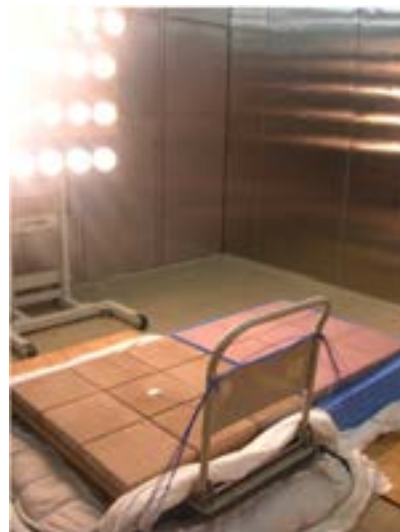
人工気象室の実験風景 (左上:日射装置、左下:非透水ブロック、 右下:透水・保水舗装)
