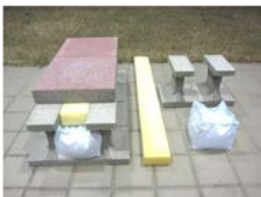
開発した透水・保水舗装 (左:組み上げた状態、中央:スポンジ、右:保水材と コンクリート製ユニット)
