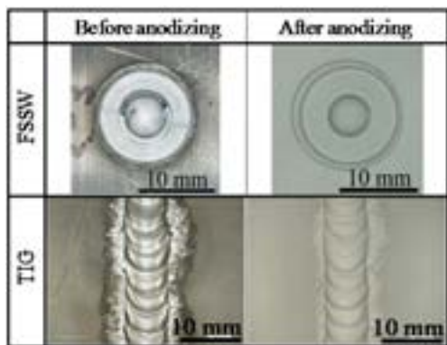
AZ31押出材の接合部外観と陽極酸化後外観
