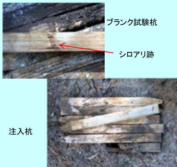
図3 ブランク試験杭のシロアリ跡と銅注入試験杭
