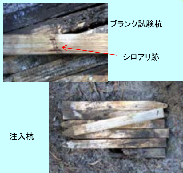
図3 ブランク試験杭のシロアリ跡と防蟻特性のある銅注入試験杭
