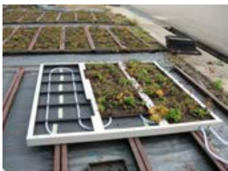
開発した融雪型耐雪型システム (パネルの配管と常緑キリンソウ植栽パネル)
