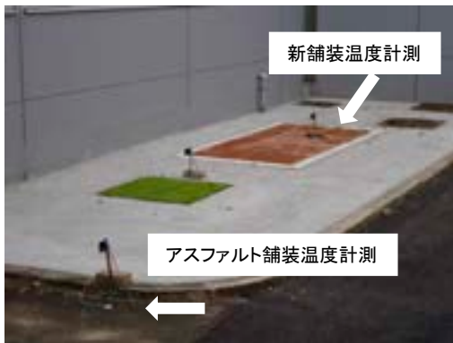
開発した透水・保水舗装と計測の状態 (左下:アスファルトの表面温度の計測、 右上:ユニット表面温度の計測)
