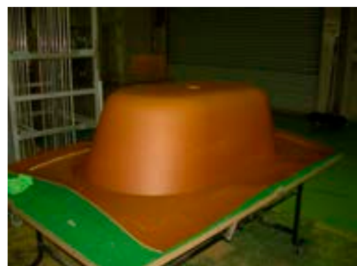
バスタブ型の真空成形結果 (古米粉とポリプロピレン)
