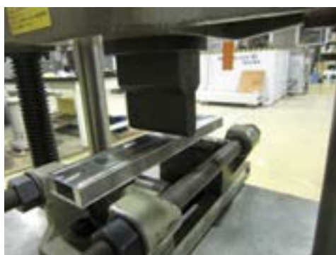
口型構造体の三点曲げ試験の外観写真と試験後の試料写真(FSW)
