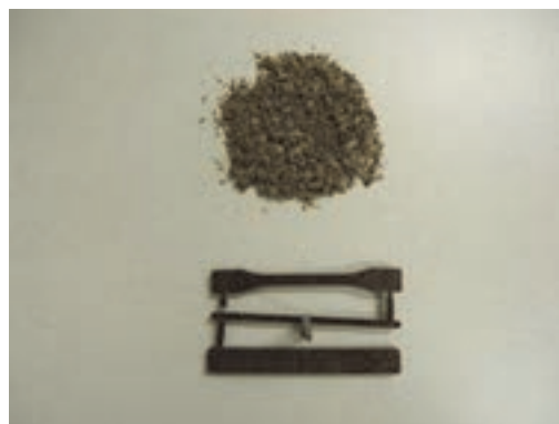
試験片(小型射出成形機) (上:射出成形用に粉砕したハトムギ/PPプラスチック、下:物性評価用試験片)
