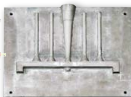
100回程度利用した状態(1000回の利用でも損傷等の問題はない) アルミの厚板に模型を配置しねじ止め、この上に枠を置き鋳物砂を押し固めて成型を作成 所定の時間の加圧後に振動しながら抜き取られる
