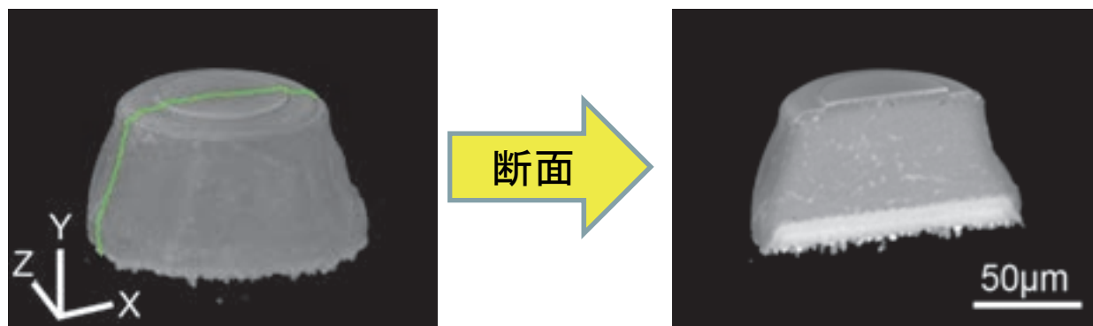
図1 CT画像を基にしたはんだ接合部の3Dレンダリング画像 【放射光X線CTを用いることで非破壊での観察が可能であり内部の状態を三次元的に把握することができます。】
