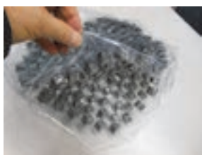
袋の内部に直方体の小体を貼り付ける
