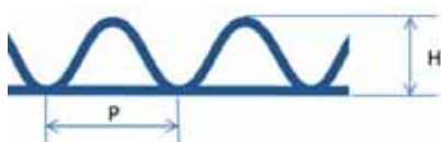
図 フィルター断面の構造 (コルゲート構造)
