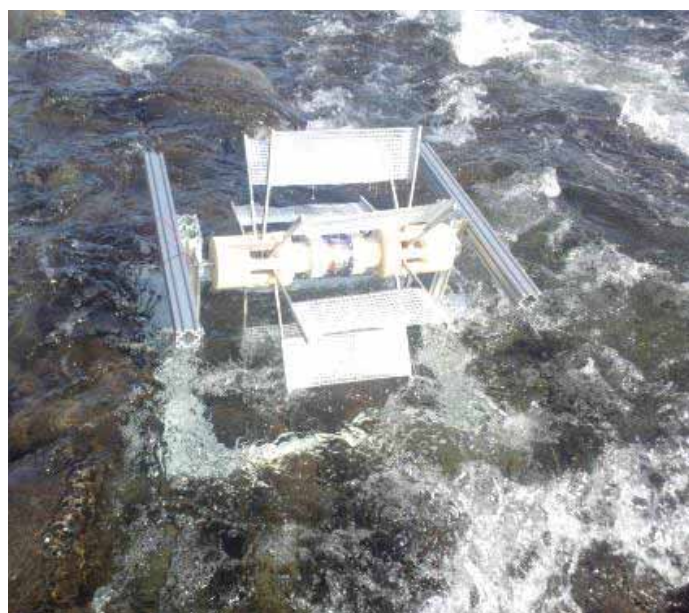
図1 試作水車による発電実験
