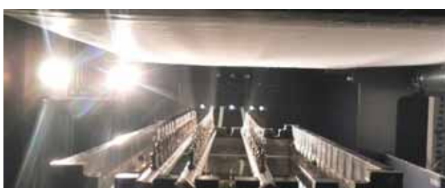
図1. PUとPVAの同時紡糸状態 (右の1ノズル列でPU、左の2ノズル列でPVAを紡糸)
