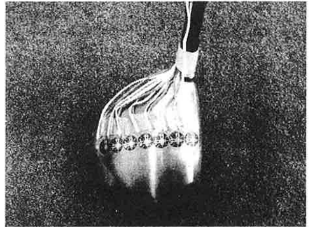
図1 試作したゴルフクラブとひずみゲージ
