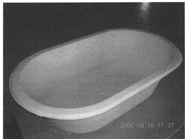
図1 試作した大型真空成形品(バスタブ)
