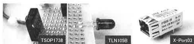
図3 センサノード主要構成部品
