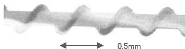
図 3. らせん溝構造部での色の混合状態
