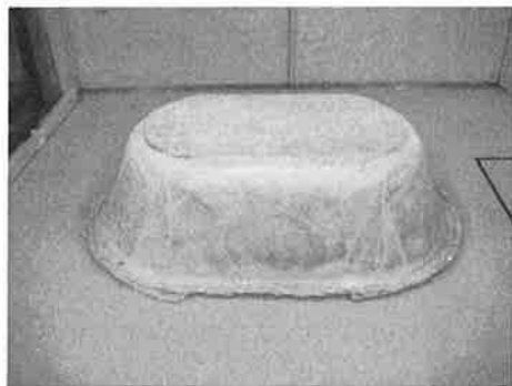
図2 ポリ乳酸布をポリ乳酸水溶性エマルジョンを用いて積層した製品
